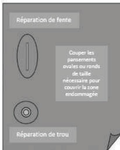
**A.** Après avoir localisé et marqué la position du trou ou déchirure sur le liner, tout d'abord, vérifier si la surface autour de cette zone endommagée du liner est propre, sèche et ne contient pas de pli, de boue, etc.
